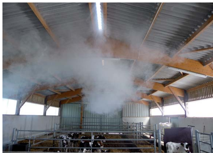
Observation du circuit d'air par fumigène
